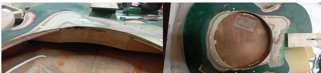
Gleichzeitig schleife ich auch an dem Frühstücksbrettchenring, um ihn an die Form der Gitarre anzupassen. Die Abflachungen habe ich mit der Flex und einer Schleifscheibe ausgeführt. Dabei hat sich der Holzring durch die Wärmeeinwirkung verformt und ich mußte einen Bereich vorläufig herausnehmen. Den vorderen Bereich mit der Erhöhung für den Steg-Tonabnehmer leime ich nun ein. Das muß wieder trocknen.
