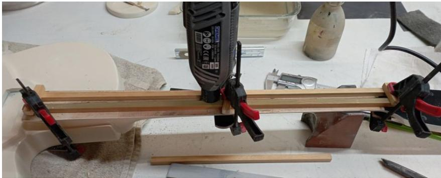
Nachdem der neue Halsstab eingepasst und eingesetzt ist, decke ich die Nut mit Kreppband ab, damit kein Leim in die Fugen eintritt.
