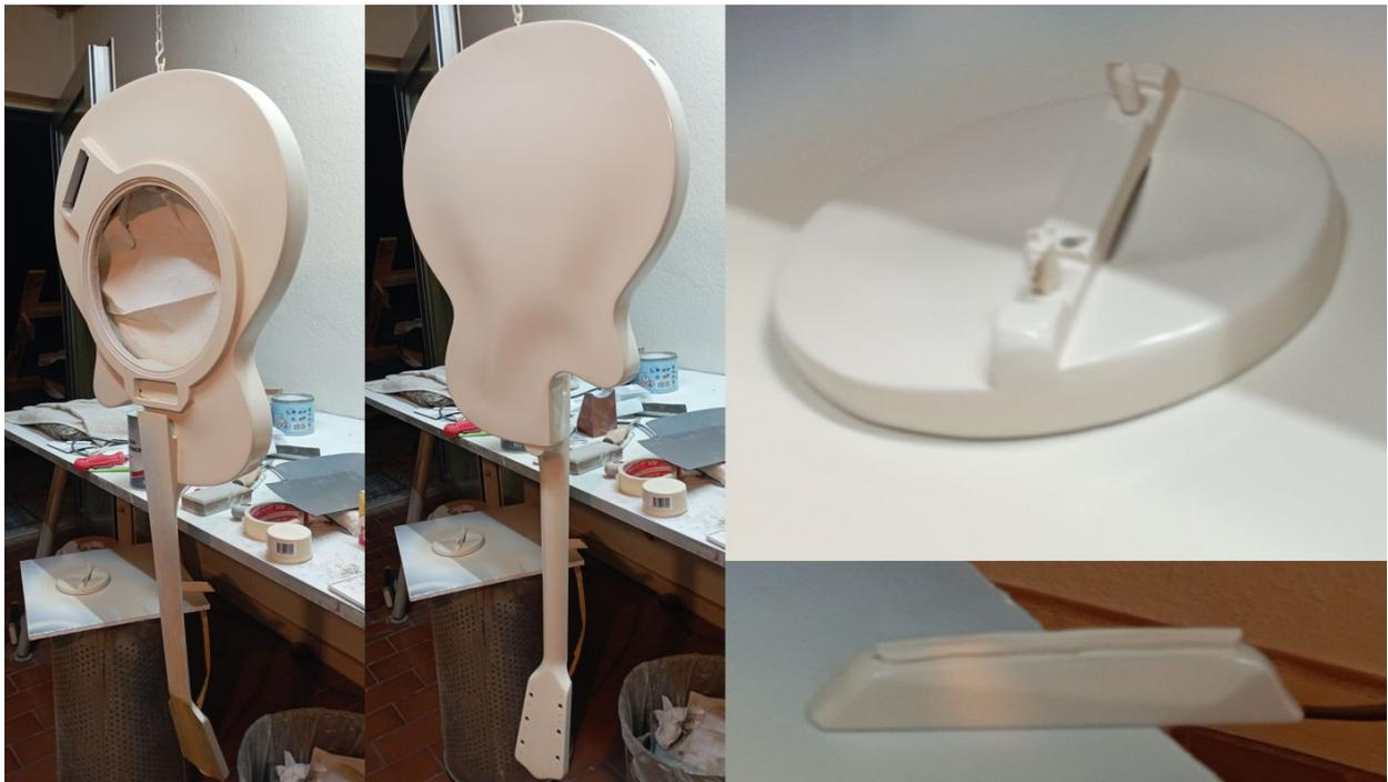
Jetzt korrigiere ich die letzten Fehlstellen, schleife es mit 1000er Schleifpapier nass ganz glatt und lege es beiseite. Die letzte Lackschicht werde ich erst aufbringen, wenn der Halsstab eingesetzt ist und alle Öffnungen und Bohrungen fertiggestellt sind.
