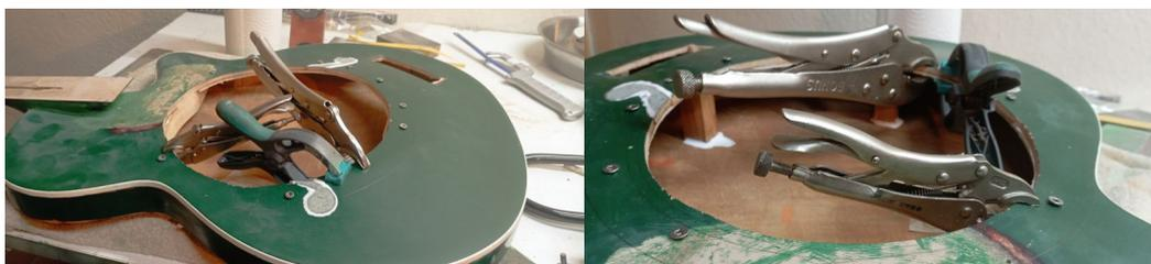
Vorn am Hals hat sich im Laufe der Jahre die Decke etwas angehoben. Da der Bereich durch mein Frühstücksbrettchen fast komplett abgedeckt wird, fülle ich nur den Spalt mit Holzleim und glätte den gesamten Bereich.
