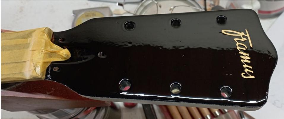
Nach der Trocknung decke ich den schwarzen Bereich komplett ab und befasse mich mit den Fehlstellen im Elfenbein. Erst einmal grundiere und lackiere ich die Stellen, wo ich bei Korrekturen durch die Grundierung durchgeschliffen habe und wo Spachtelmasse aufgetragen wurde, bis alles gleichmäßig den Elfenbeinton erreicht hat.
