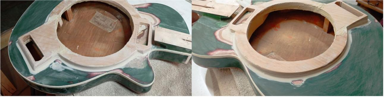
Dann schleife ich den inneren Bereich und die Oberfläche des Rings, bis der Fressnapf genau passt. Dabei achte ich darauf, daß die Mensur (Abstand vom Sattel zum Mittelpunkt des Resonators stimmt). Abschließend fräse ich noch eine Vertiefung in den Rahmen, damit der Resonator fast genau bündig in der Höhe ist. Die Fräsung ist etwas größer, als der Resonator, da die Farbe noch etwas füllen wird.
