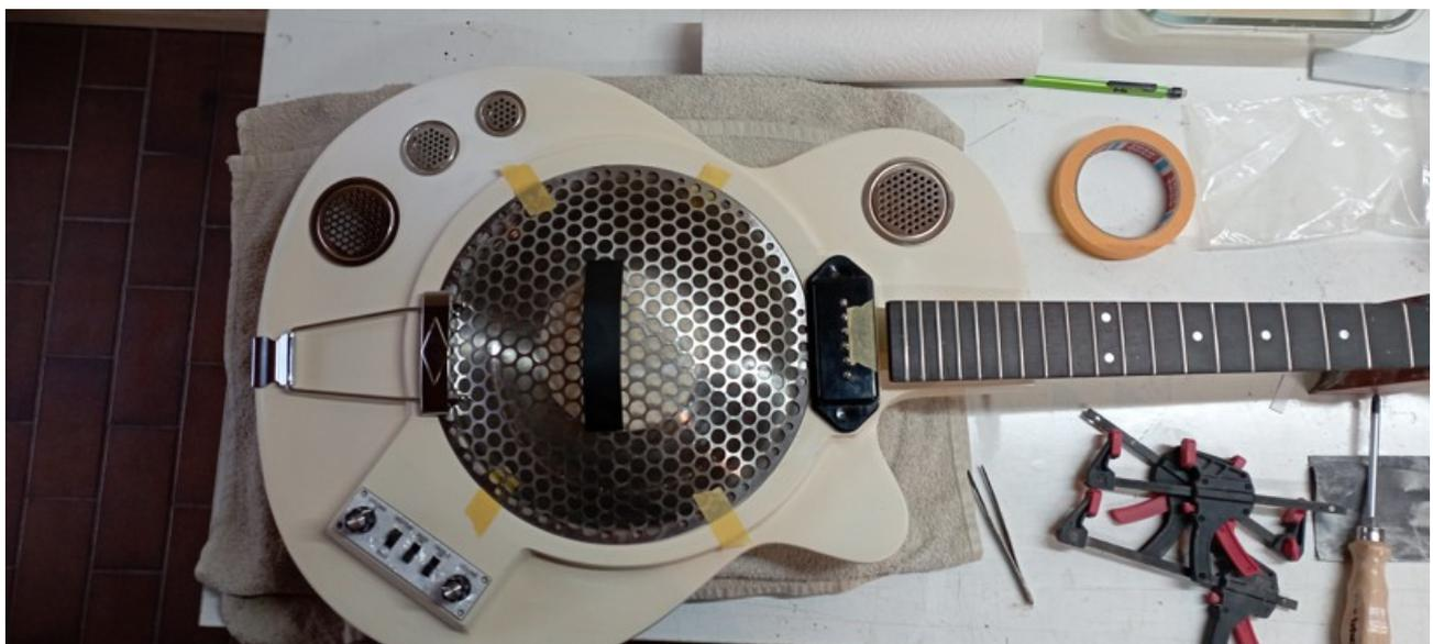
Um die Bohrungen für die Resonatorabdeckung markieren zu können, muß ich alle Positionen am Resonator mit der Minidrill überarbeiten, da der Resonator die Bohrungen leicht überlappt. Damit fixiere ich
